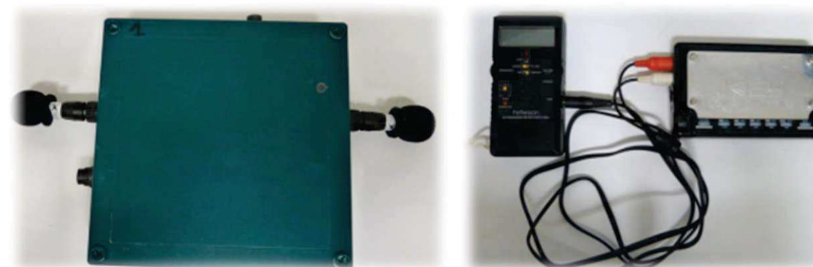
Matériel de détection ultrasonore utilisé (SM2 Bat à gauche et détecteur Pettersson à droite)
